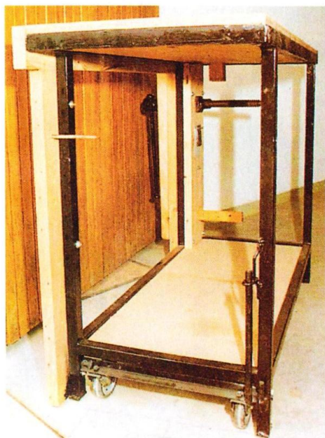
Перемещать верстак можно за счёт пары колёс на поворотной опоре. Положение опоры с колёсами меняют ручкой.
