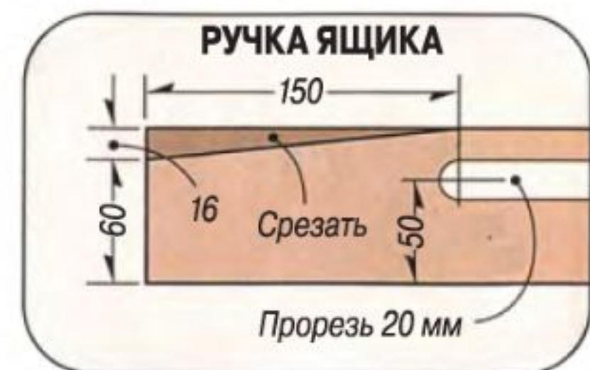
ручку **CC**. Детали ящиков склеивают и дополнительно соединяют шурупами.
