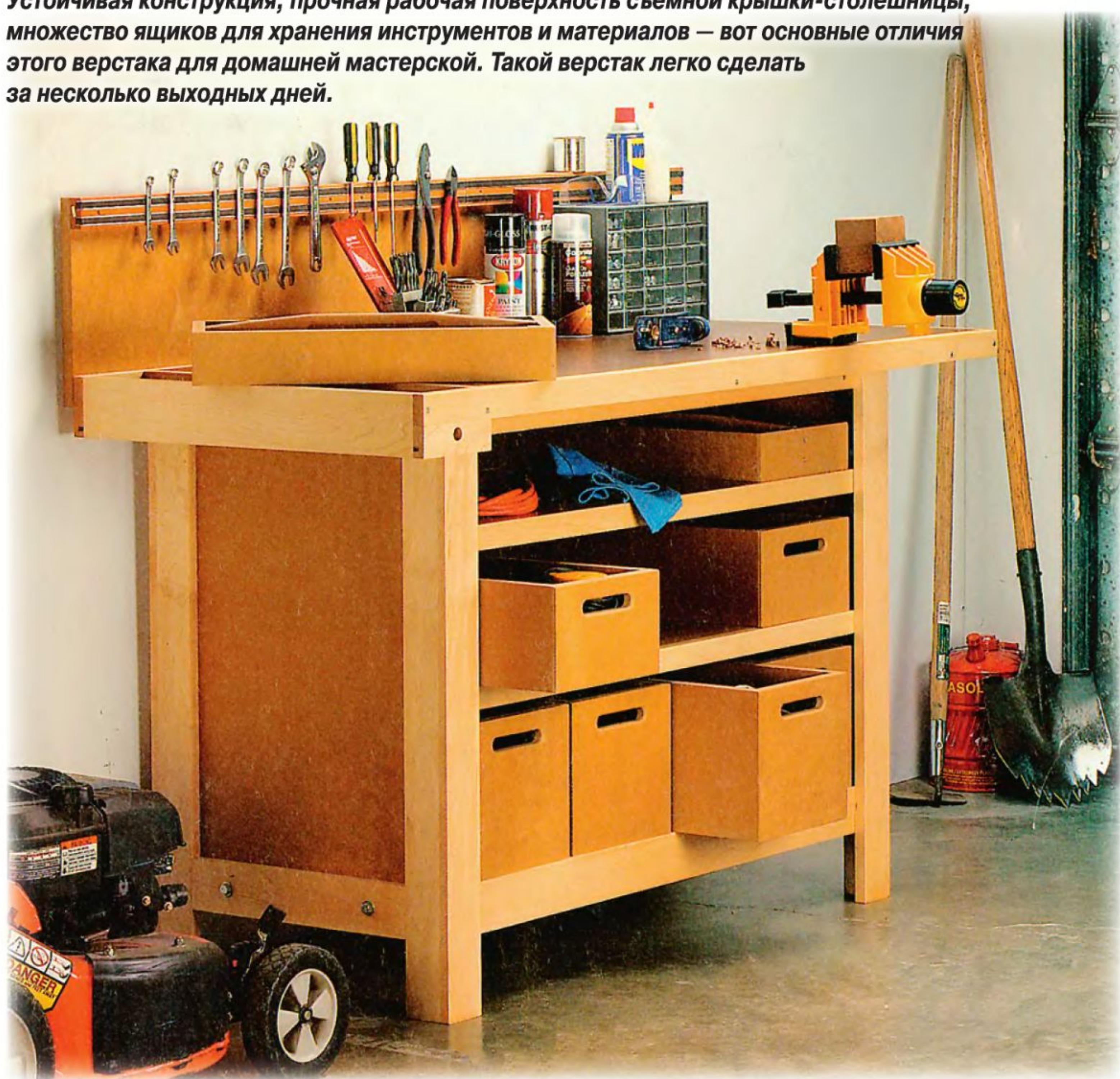
Этот верстак имеет простое по конструкции, но крепкое основание, которое служит опорой для крышки и местом для хранения инструментов. Схема сборки верстака показана на **рис А**. Для упрощения конструкции основные части верстака собраны на болтах.
