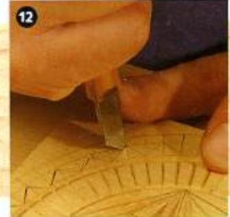
**12.** Долотом наметьте контуры «зубчатого» круга. Две выемки должны сходиться под углом приблизительно 90°. Для этого держите нож как кинжал. Вонзите острие в древесину и ведите им по поверхности.
