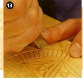
**13.** Когда вы достигнете необходимой глубины, опустите лезвие вдоль прорезаемой канавки до ее соединения со следующей линией. У вас получится насечка, которую вы постепенно прорежете до необходимой глубины.
