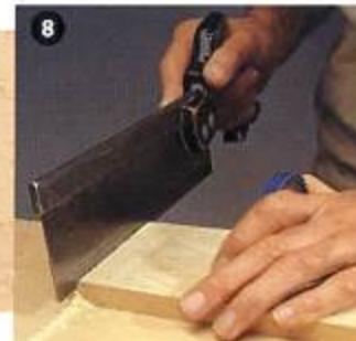
**5.** На верхнем ребре панно выберите фальц. Это позволит установить крышку так, чтобы она была немного наклонена вперед. Гораздо удобнее пользоваться рейсмусом, чем удерживать в правильном положении линейку и одновременно нож. Начинайте работать с краев линии. Как и в предыдущих случаях, сначала сделайте
