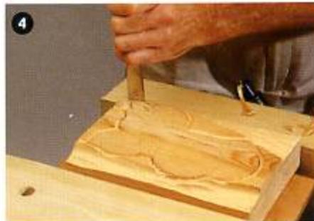
**5.** Той же стамеской выберите поверхность до намеченной глубины. Затем начинайте обработку по заданному профилю. На этот раз используйте различные стамески, чтобы как можно точнее следовать линиям орнамента. Не опускайтесь ниже уровня фона.
