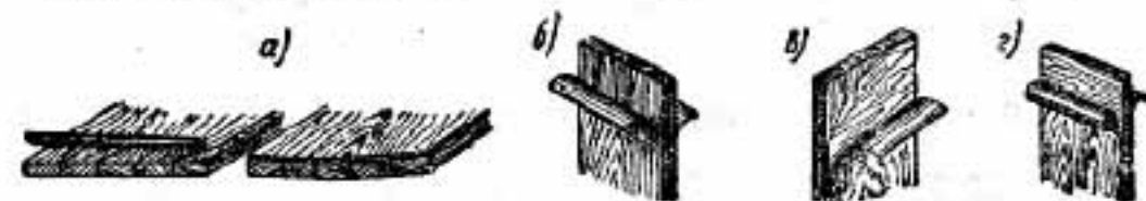
Рис. 128. Оклейка щита фанерой
