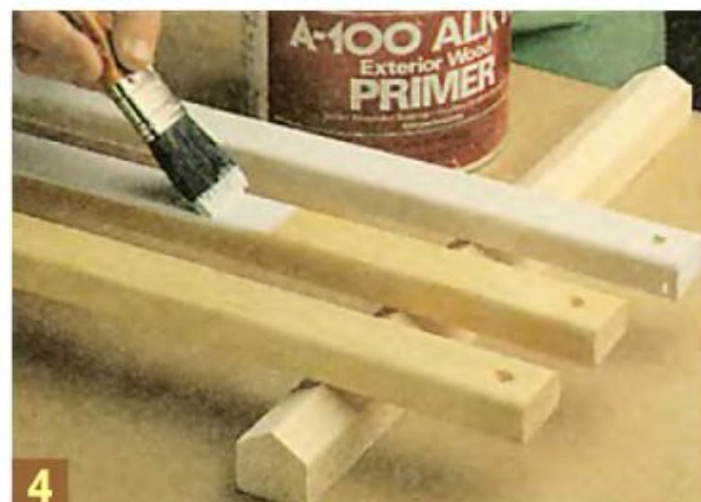
4 Качество покраски во многом зависит от предварительной грунтовки поверхностей.
